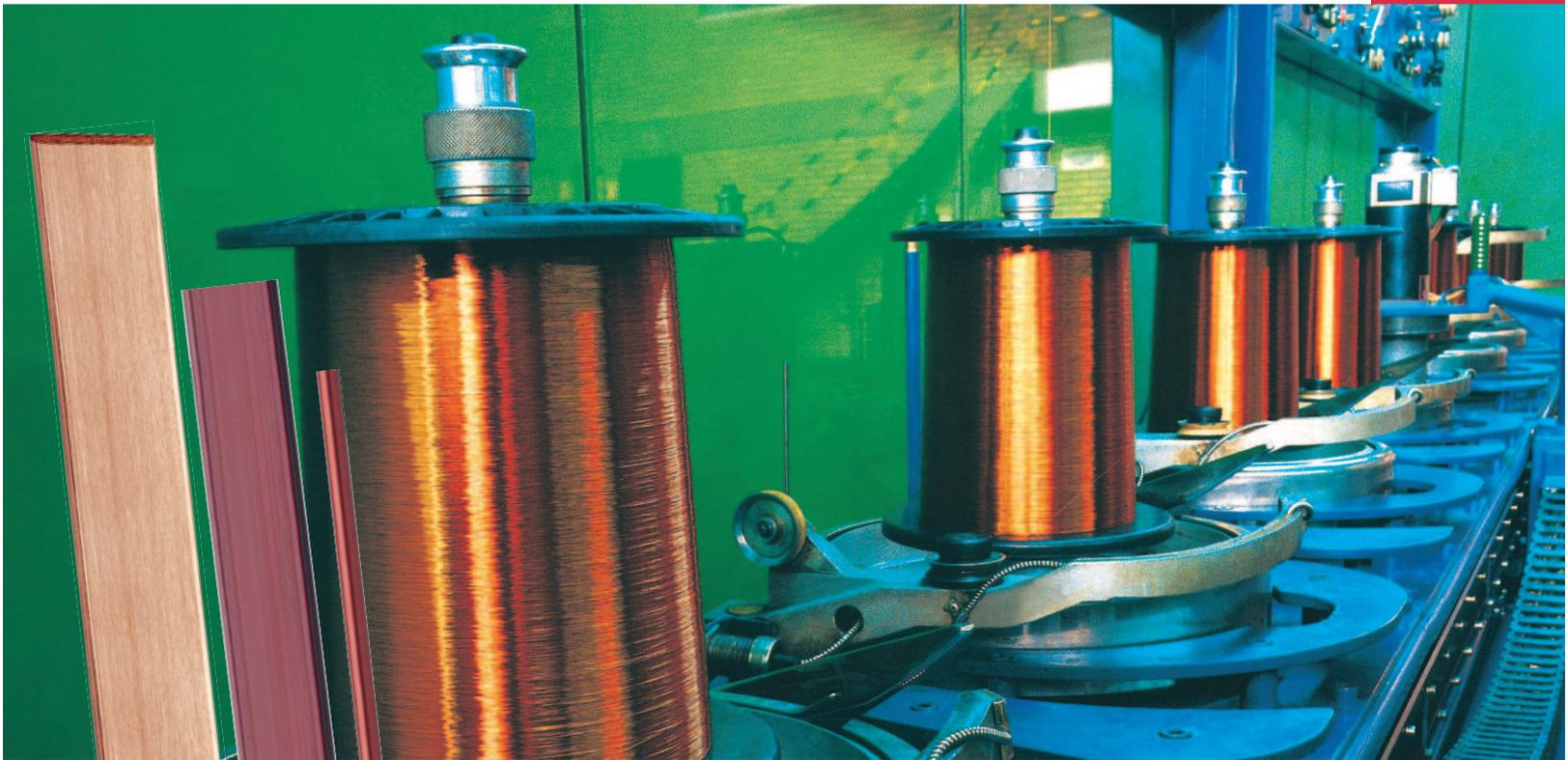
*Los Alambres Magneto son utilizados para la fabricación, reparación, servicio o mantenimiento de equipos y maquinaria eléctrica, para el embobinado de motores, transformadores, balastos y otros similares.*
