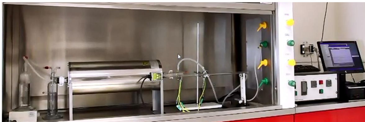
Equipo para realizar el ensayo de baja emisión de humos densos, tóxicos y corrosivos según IEC 60754-1-2
