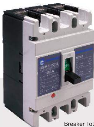
Breaker Totalizador 3P - 100A 35KA/415V
