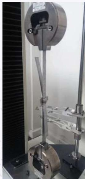
Soporta el valor mínimo de fuerza máxima que debe sostener el montaje, siendo para la abrazadera de 5/8" de 450Kgf.
