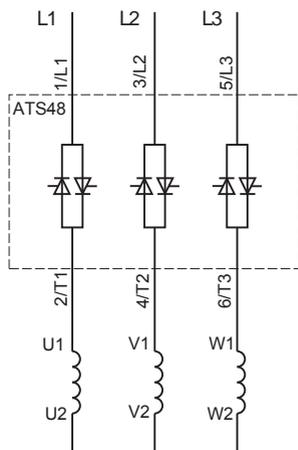
El acoplamiento del motor depende de la tensión de alimentación, **en este caso en estrella**
