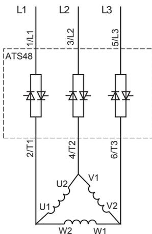
El acoplamiento del motor depende de la tensión de alimentación, **en este caso en triángulo**
