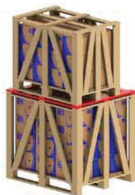
Figura 5.5 - Utilización de varas adicionales para apilamiento.
