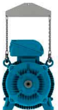
Figura 4.6 – Uso de barra separadora en el izamiento.
